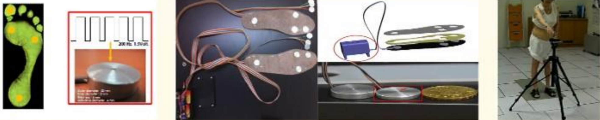
足底低閾值機械振動回饋系統設計 攜帶式可調控感知閾值下足底振動鞋墊系統和改良後輕量化系統設計 巴金森病患者執行站立動態功能取物動作
